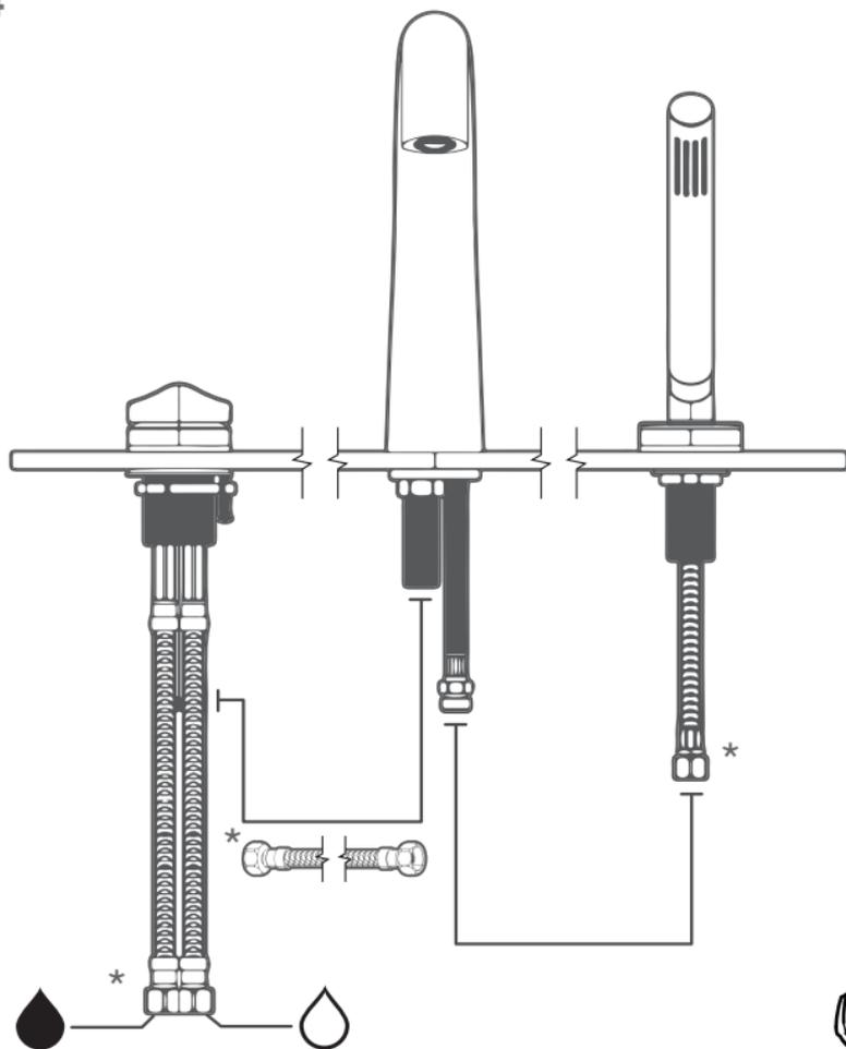
\* Visser d'abord à la main, puis, avec une clé à molette serrer 1/4 à 1/2 tour de plus. Assurez-vous de vérifier l'étanchéité des connexions.
