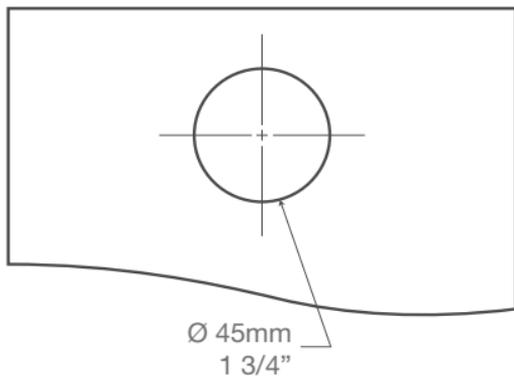
Le mitigeur peut être installé n'importe où dans un rayon de 4 à 12 po du bec.
