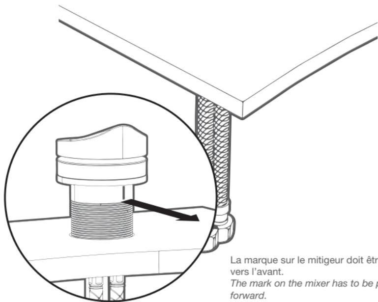
La marque sur le mitigeur doit être positionnée vers l'avant.
